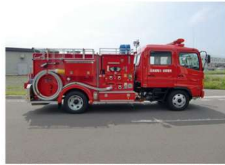
第 2 図：水槽付消防ポンプ自動車
