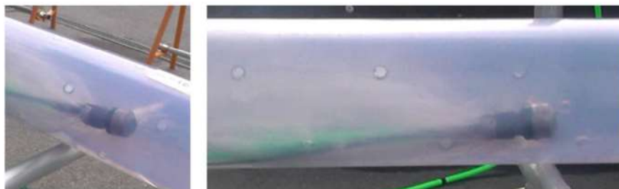
添付 6-3(4) 図 管内清掃装置進行時の様子
