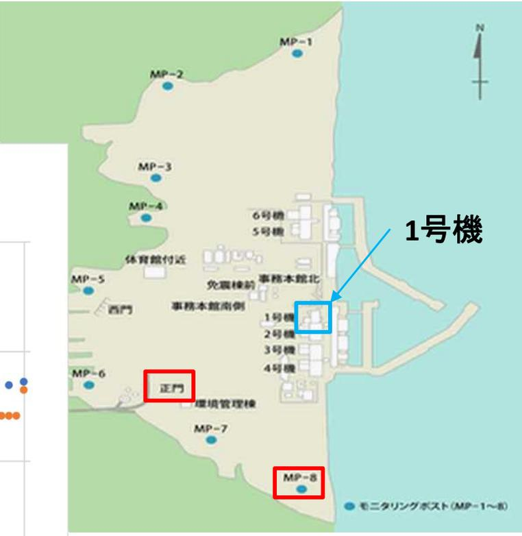
② 正門付近及びMP-8付近の空間線量率が上昇する前に1号機原子炉建屋内で線量率が上昇。
