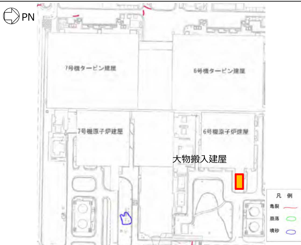
図32 中越沖地震後の亀裂・噴砂分布図※
