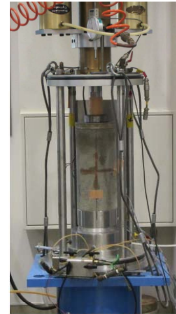
一軸圧縮試験の状況
