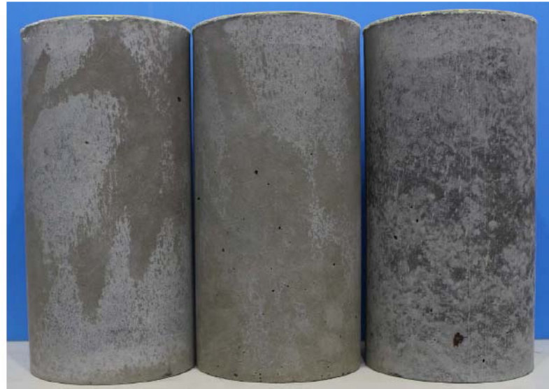
セメント改良土の室内試験用供試体
