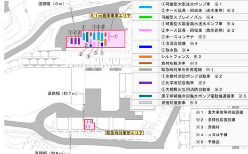
第2図 保管場所の可搬型設備配置 (1/3)
