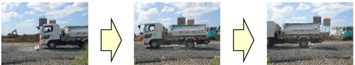
第2図 段差復旧前の走行性能検証
