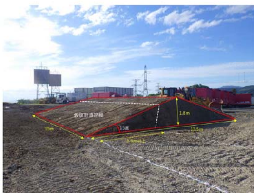
第3図 斜面崩壊後を模擬した土砂
