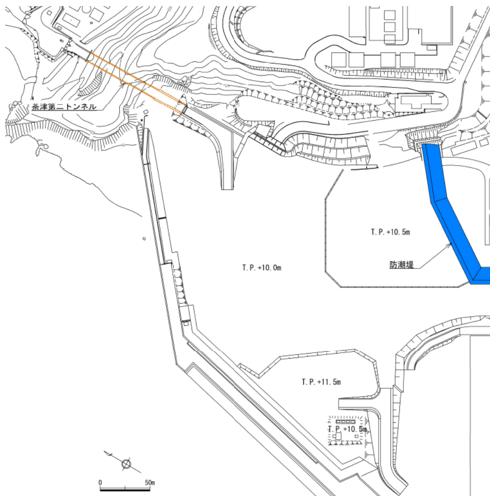
参考図2 既存防潮堤等の撤去後の地形
