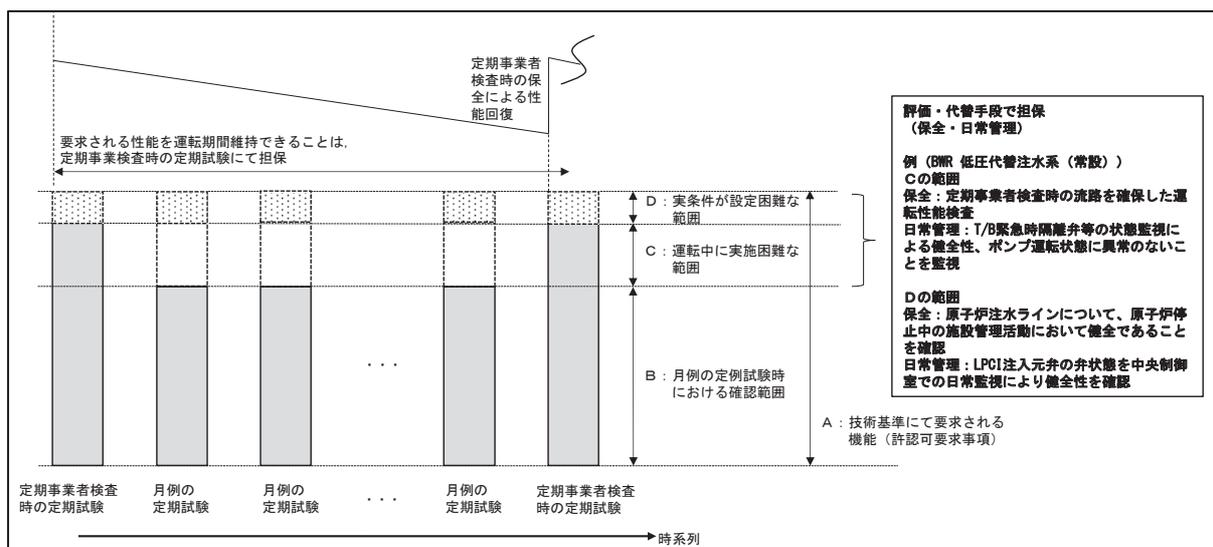
上記イメージのとおり、設置許可や技術基準にて要求される設備の性能を担保するための行為として、定期事業者検査時に実施する設備の保全及び定期試験にて確認を実施している。また、運転期間における設備の動作可能性の確認行為として、確認が可能な範囲において日常管理としての盤面監視及び巡視点検、月例で実施する定例試験にて確認しており、設備の信頼性を担保している。
