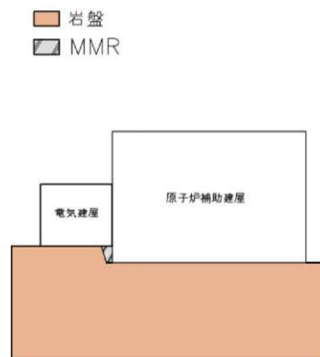
第3図 電気建屋の設置状況（断面②）
