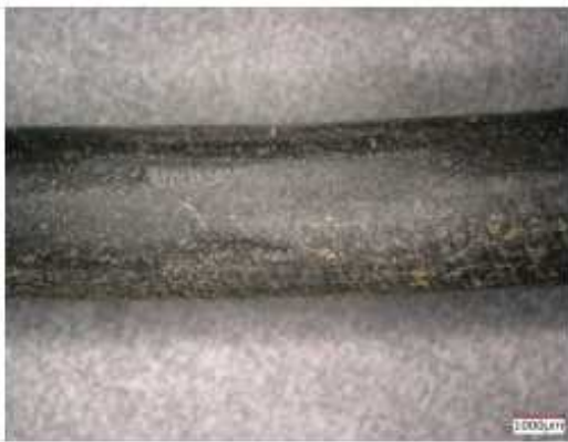
(c) T1 加速劣化ケーブル (×30)
