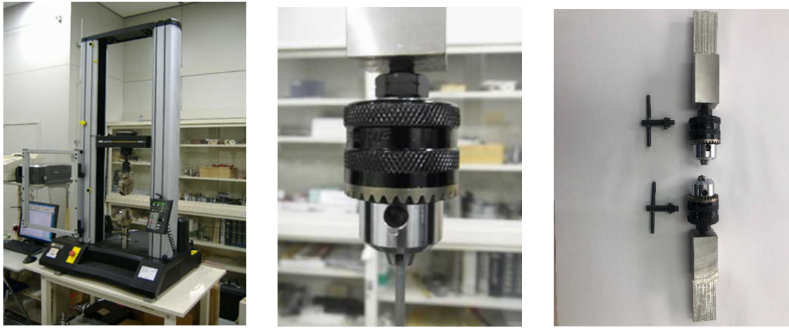
(a) 引張試験機外観 (b) 管状供試体取付部分 (c) 取付治具外観
