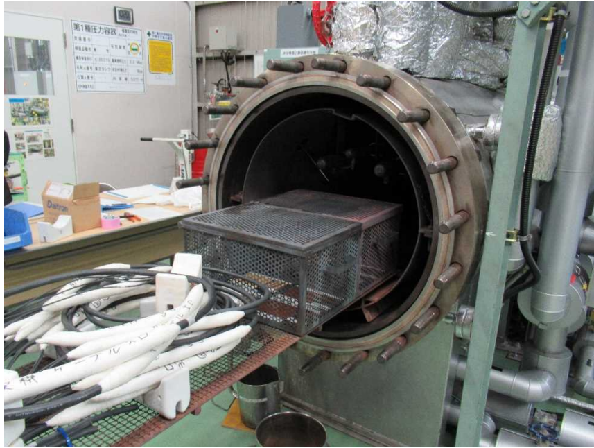
図 2.2.16 蒸気暴露試験前の試験容器とケーブル
