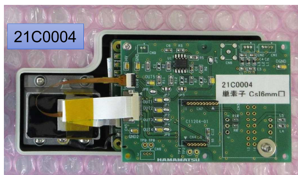
図 23 試作検出器の外形。C12137-00 のケースを使用し、既製品で使用しているものと同じ Al 製の金属容器にシンチレータおよび MPPC が樹脂で封入されている。単素子 MPPC 用信号処理回路が試作品のため、ケースを片側半分取り去って基板を乗せた形になっている。
