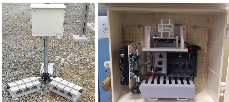
図 38 連続運用中の八角柱型検出器。検出器は昨年までの安全規制研究で開発した可搬型モニタリングポストと同型のもの（左）に内蔵している。検出器は同じ場所に設置されている（右）。松浦電弘社の自社敷地内に設置されている。この箱は防水仕様ではあるが内部の温度管理等は行っていない。この試験が終わった後は石川県が設置するモニタリングポストに隣接しての試験を予定しているため、仮置きでの試験となっている。
