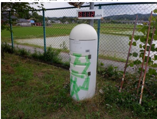
車両接触による破損
