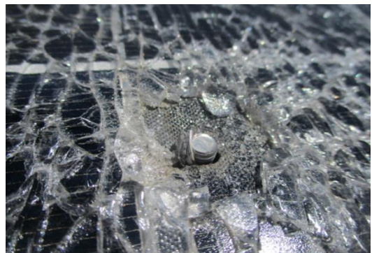
ボルトが飛び出ている
