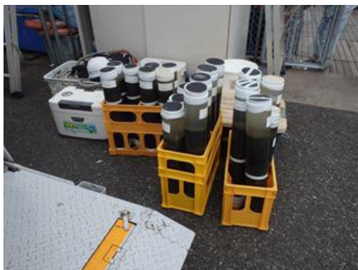
鉛直分布用柱状海底土の固定状況
