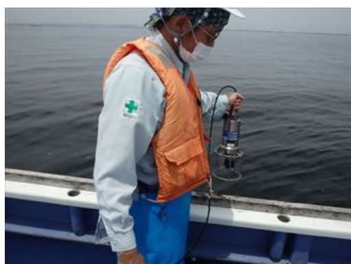
水質計による鉛直観測
