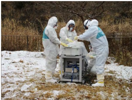
可搬型モニタリングポストの設置
