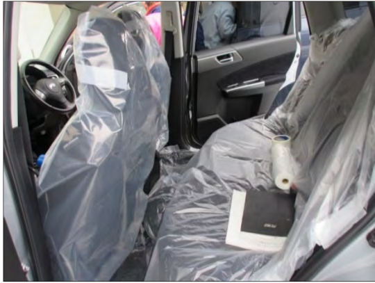
モニタリングカーの養生（出動前）
