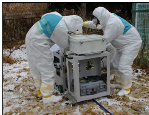
原子力総合防災訓練・要素訓練 (可搬型モニタリングポストの設置)
