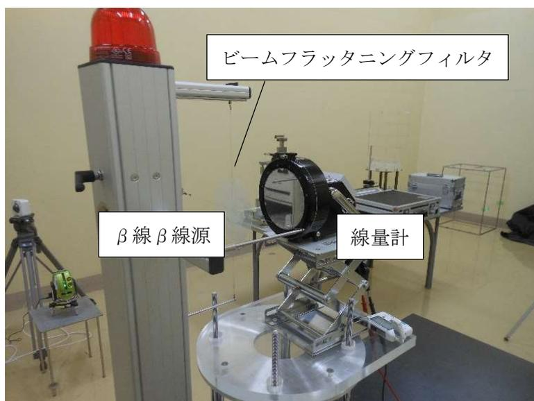
図 4-27 B社製電離箱式サーベイメータの校正の様子
