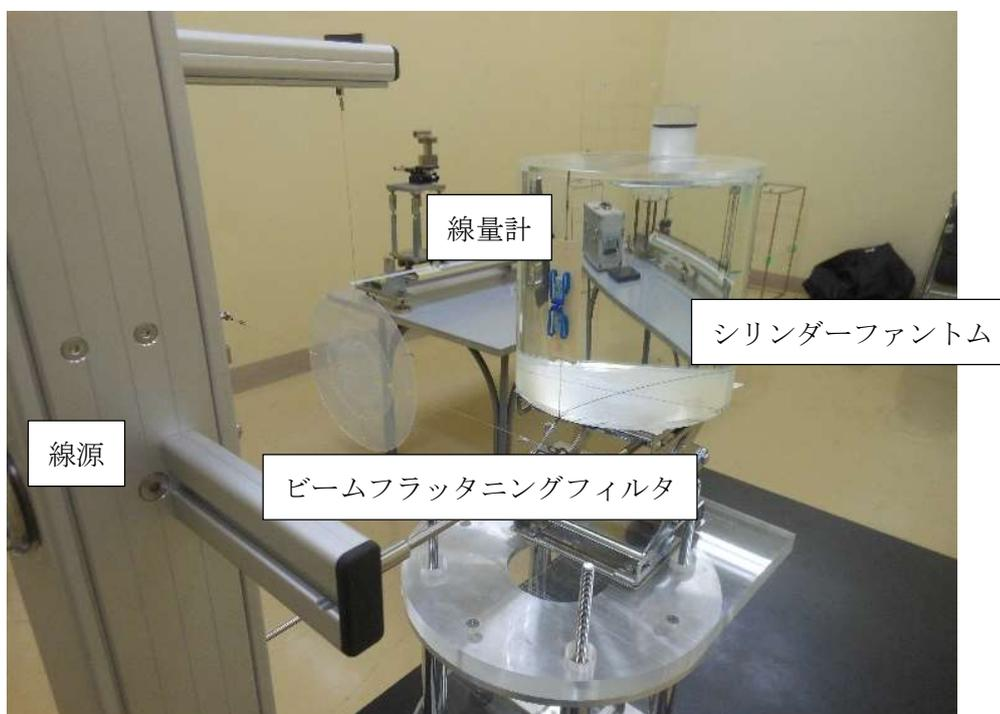
図 4-3 2 F 社製受動形個人線量計（水晶体用）の校正の様子
