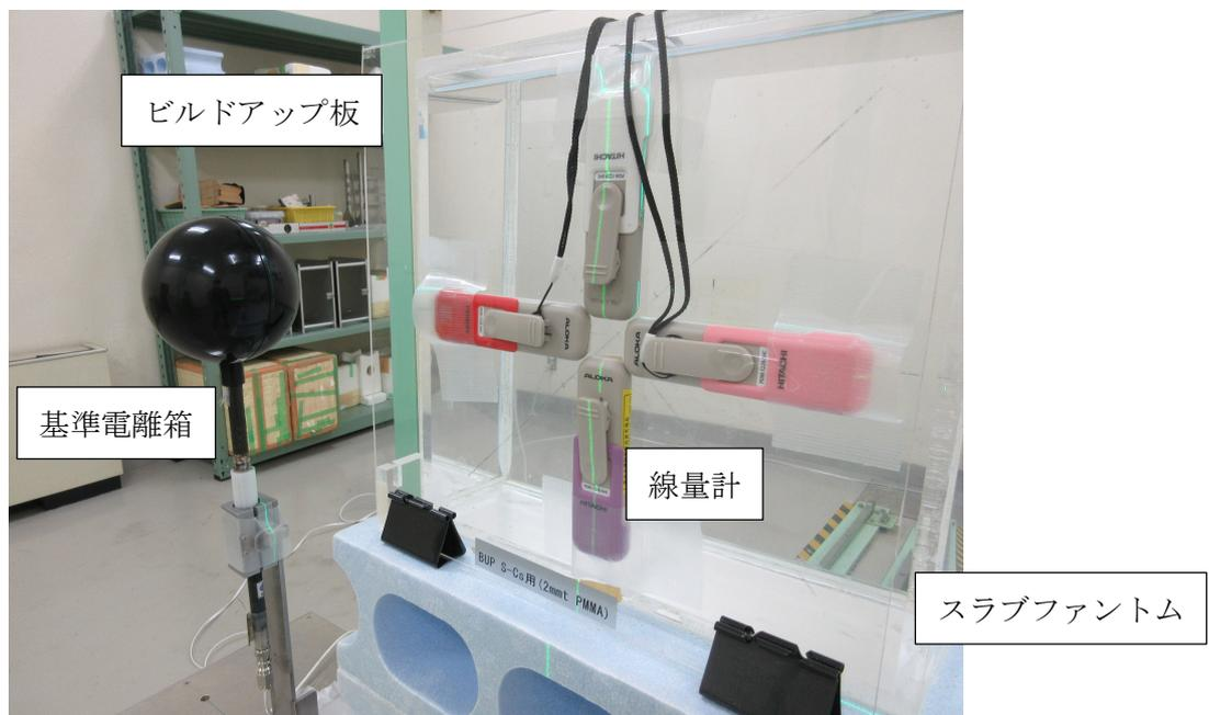
図 4-30 D社製光子用個人線量計の校正の様子
