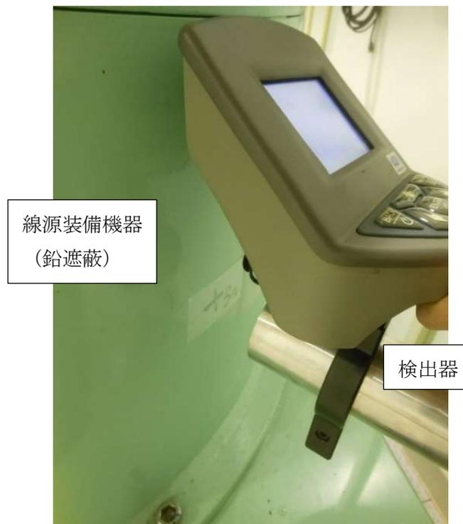
図 4-38 漏洩線量場 (線源装備機器) (#13) の測定の様子
