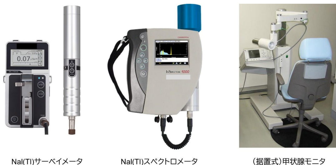
図 4. 甲状腺線量測定に用いられる機器
