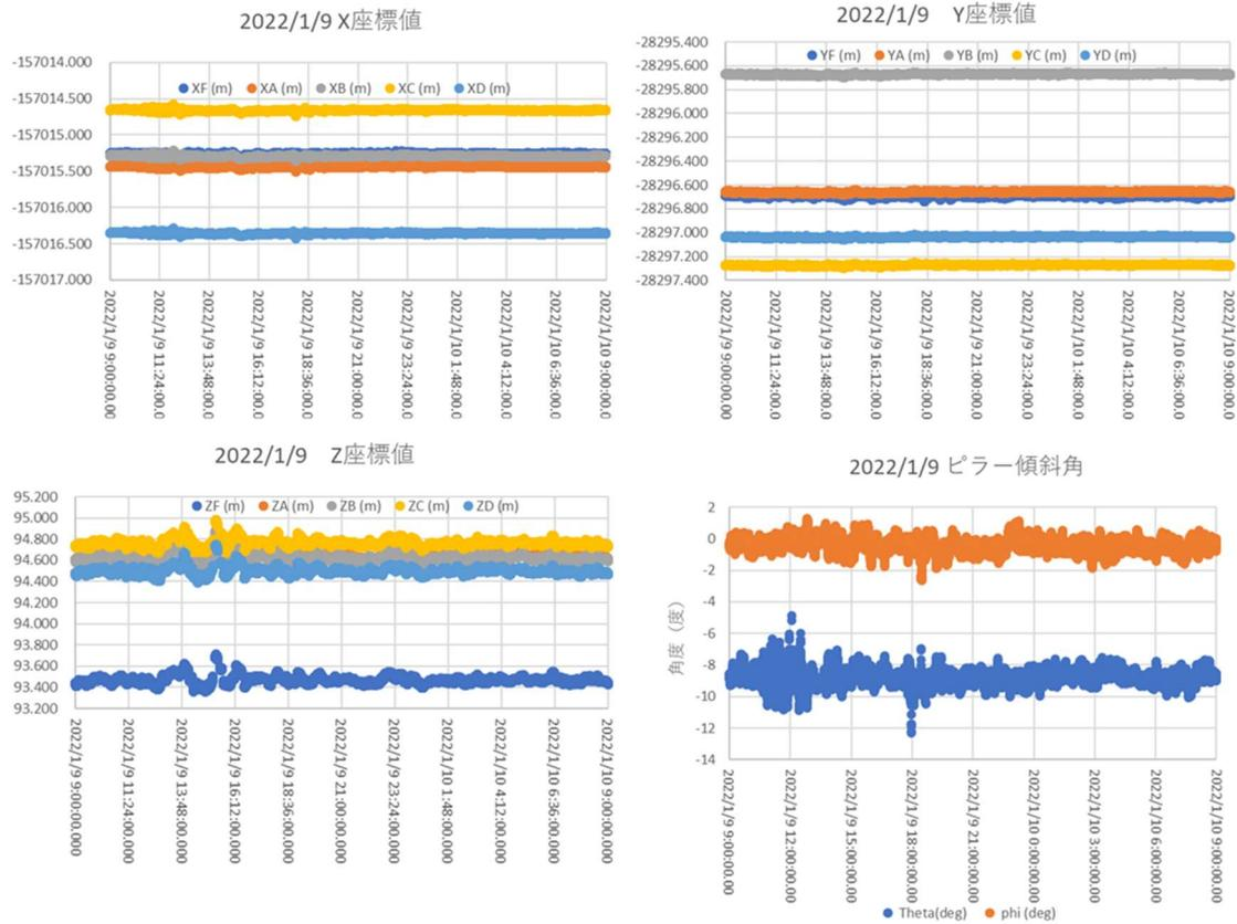
図 2-2-3-17 測位結果および傾斜補正結果時系列（水色：XF, YF, ZF）例。基準点 SNYM（実験台から 3.4 km）
