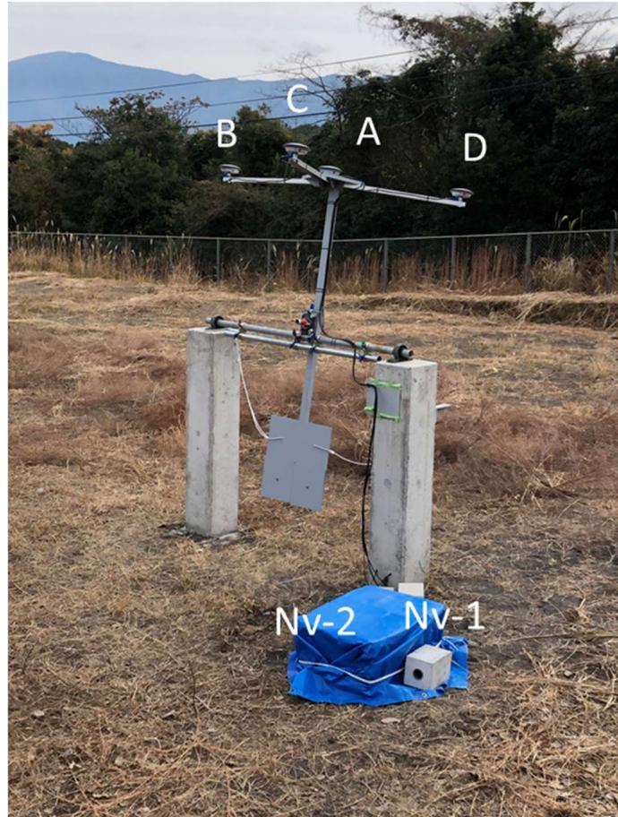
図 2-2-3-2 2 軸実験台 無風時平衡状態で D 側下がり 8 度。
