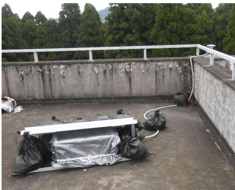
図 2-1-1-5 MAKI 観測点近傍に設置した仮設観測点 (MAK2)
