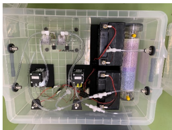
写真 4.3-2 ポンプユニット
