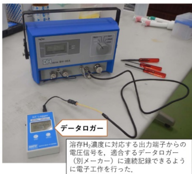
写真 4.3-5 計測値ロギング用のデータロガーを追加した溶存水素計
