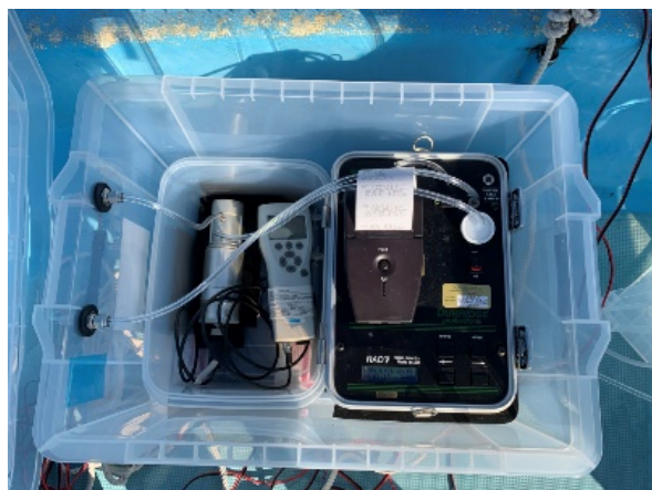
写真 4.3-1 CO 2 -Rn 測定部
