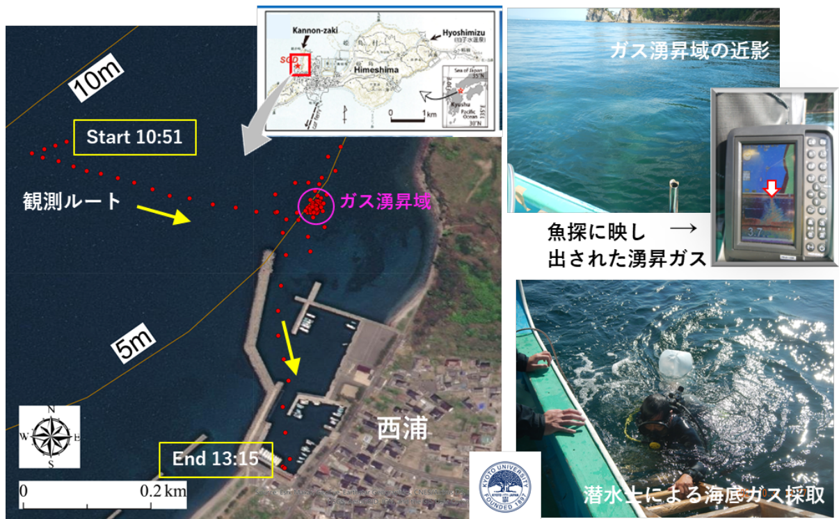
写真 4.3-10 西浦沿岸沖における曳航観測ルート (左), ガス湧昇域の様子 (右上), 潜水士による海底に流出するガスの直接採取の作業の様子 (右下)
