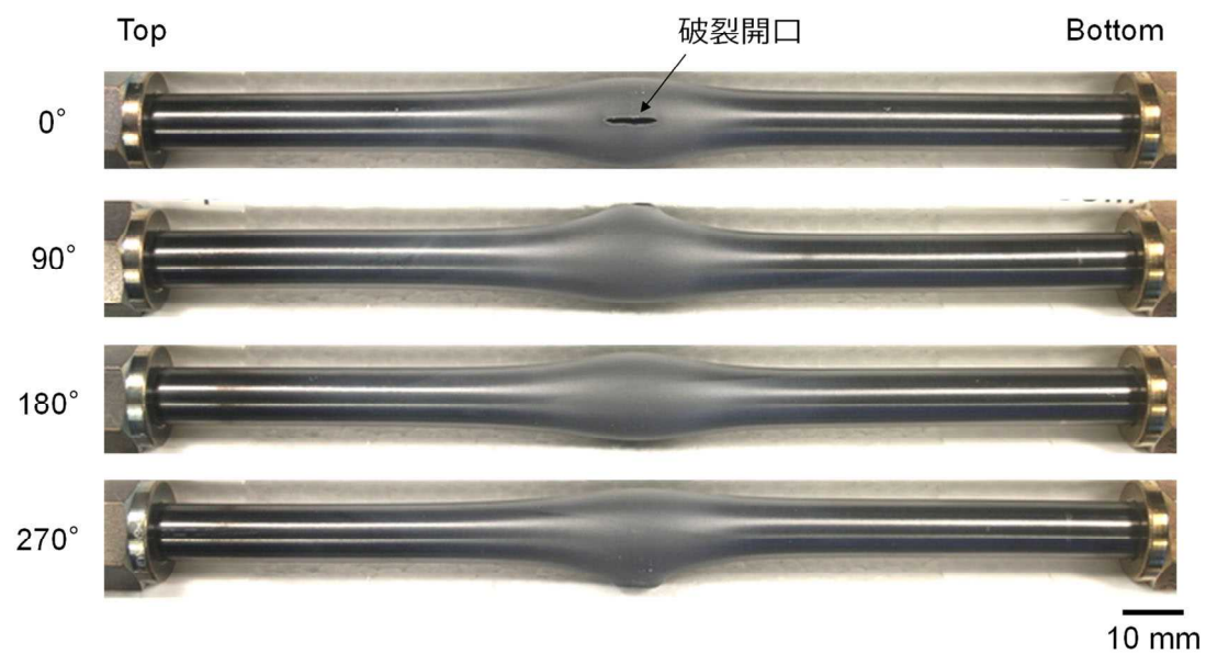
図 4.3.3-3 LOCA 模擬急冷破断試験後の試料外観の例
