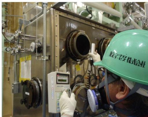
図 6.1.A2-7 線量当量率測定
