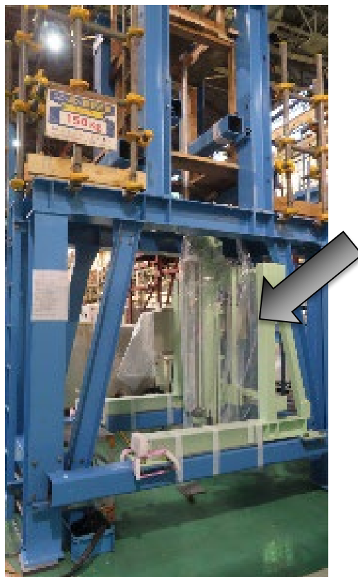
図 6.1.2-2(6) 可動装荷物駆動装置（矢印部。試験用仮設架台に組み込まれた様子）
