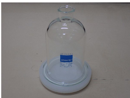
図 9.2-8 減圧容器及び減圧濾過用フィルターホルダー
