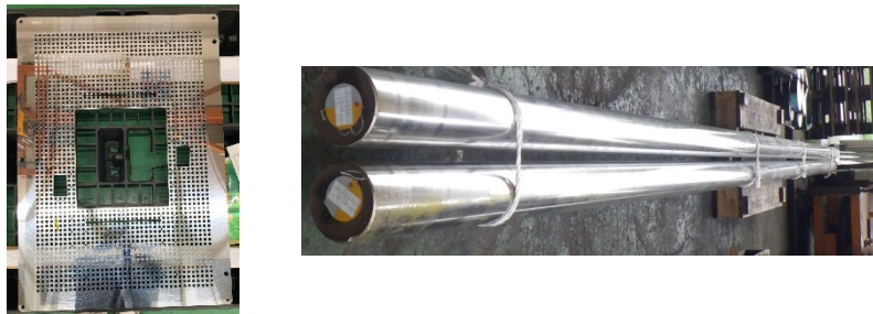
図 6.1.2-1(2) 格子板・格子板フレーム主要材料 (左から格子板 (孔開け加工済)、格子板フレーム支柱)
