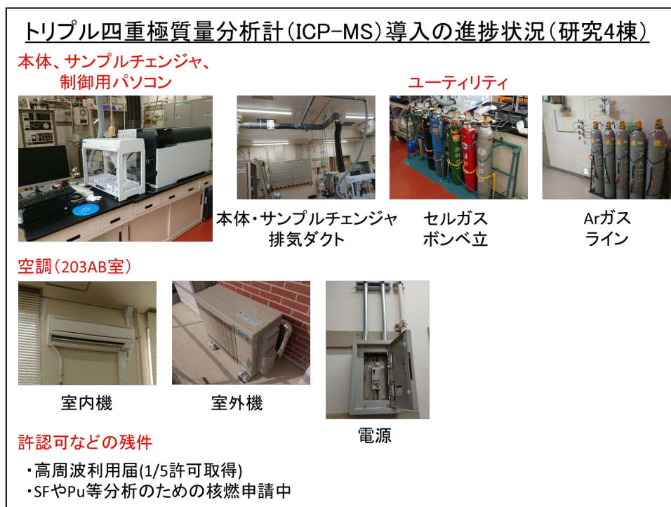
図 5.5-1 ICP-QQQ システムとそのユーティリティ及び空調機とその電源
