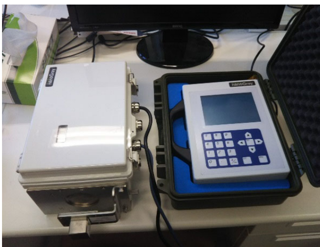
(a) センサー及び信号処理装置
