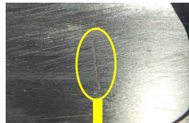
傷の代表例 (傷の長さ2.0 mm (削り込み前))
