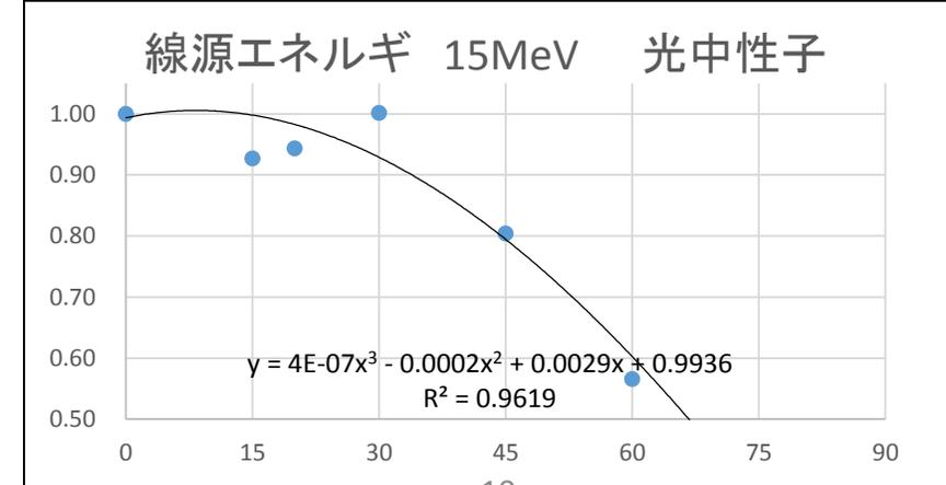
$\gamma$  /X線、光中性子ともに、入射角度による線量比変化を3次以下の多項式で良く近似できた。
