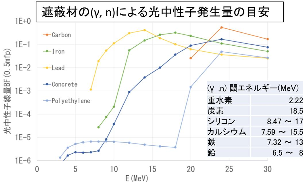
光核反応の閾値を超える高エネルギー光子の場合、遮蔽が厚くなると光中性子の線量が支配的
