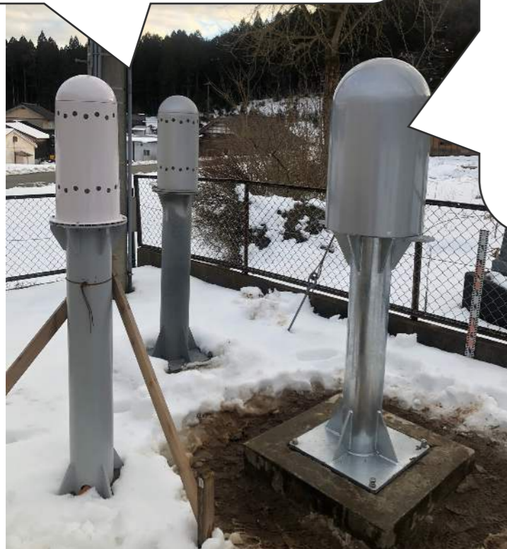
既設モニタリングポスト (赤住局: 3 inch NaI(Tl)と電離箱)
