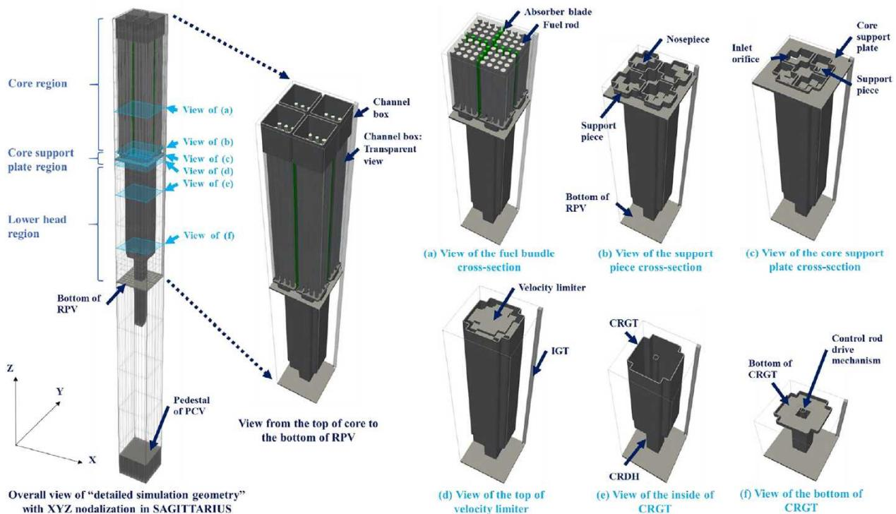
図 1 BWR 原子炉圧力容器の内部を模擬した詳細幾何形状モデル
