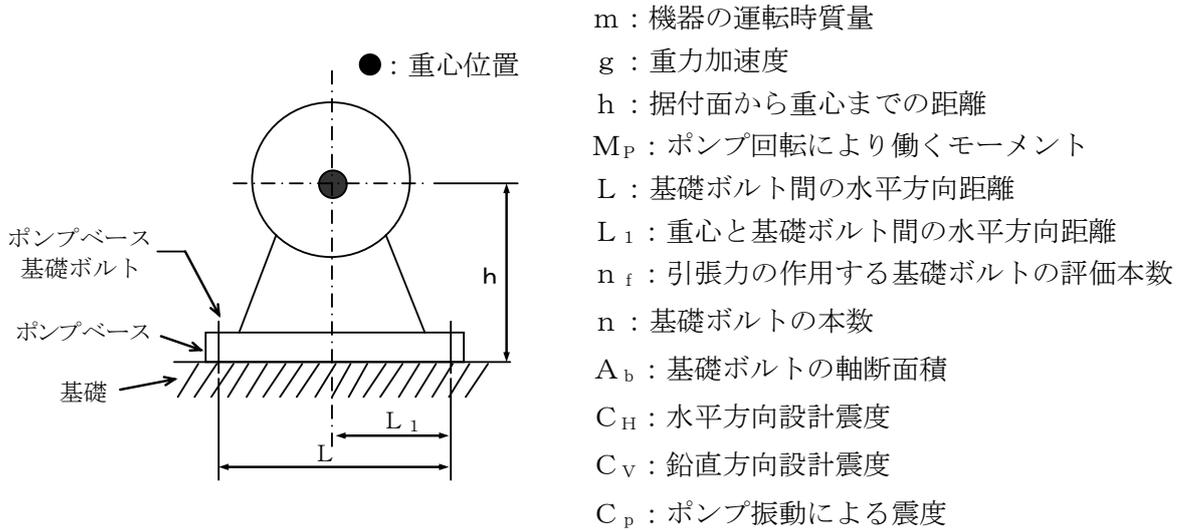
$$\text{基礎ボルトに作用する引張力} : F_b = \frac{1}{L} (m g (C_H + C_P) h + M_p - m g (1 - C_V) L_1)$$
