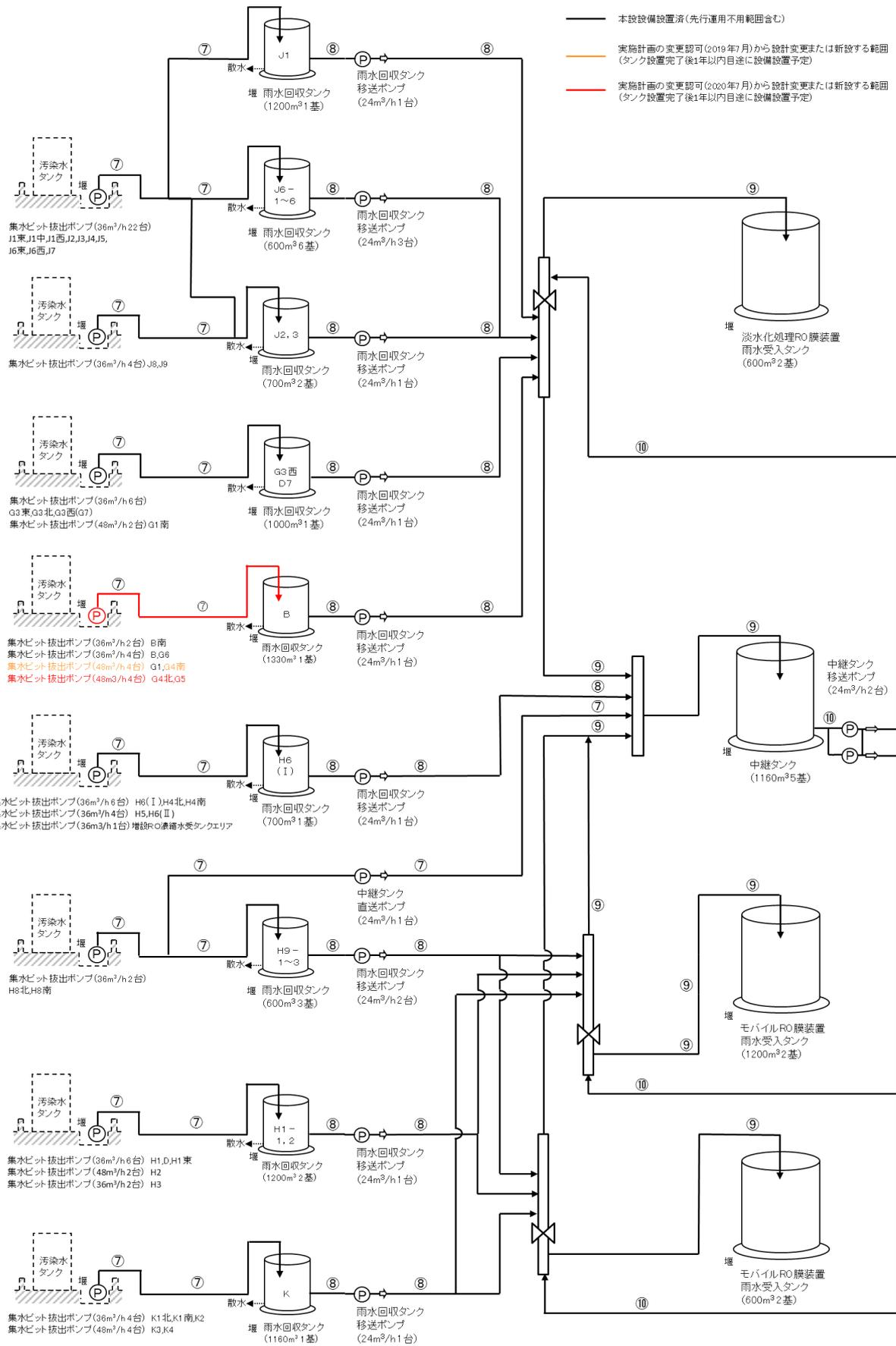
図2 雨水移送ラインの設置範囲図
