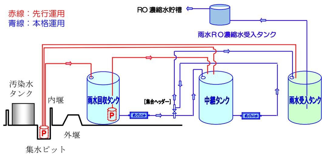
図3 雨水処理設備等の先行運用例
