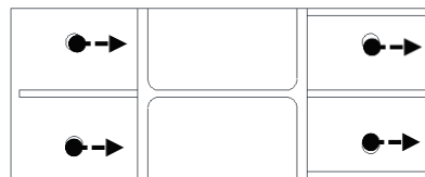
図 3-17 アンカーボルトに生じる荷重の例 取水槽除じん機エリア水密扉（東）
