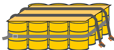
添図 5 - 1 - 3 平積み時の固縛対策 (固縛及び固定)
