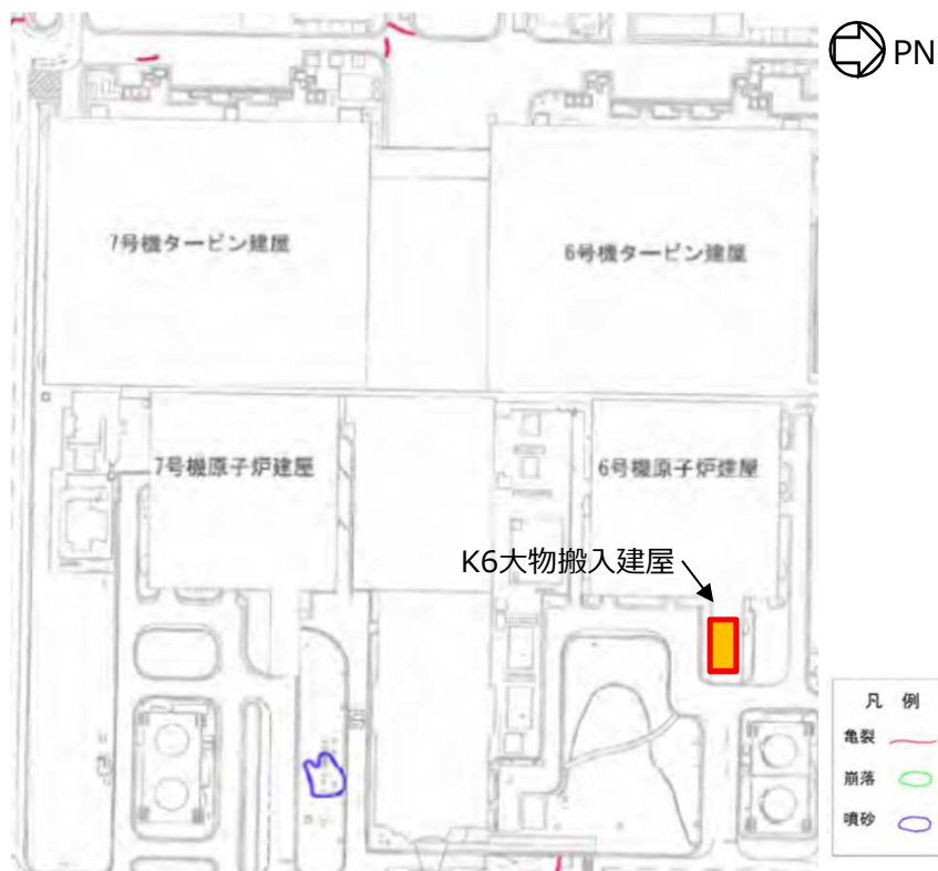
図19 中越沖地震後の亀裂・噴砂分布図
