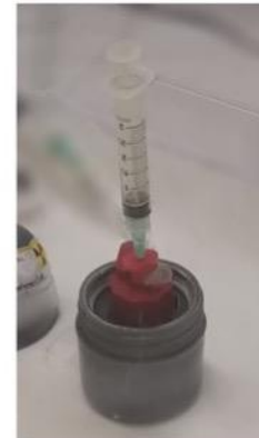
希釈液400 \mu lを入れた注射筒 (針は38mm)を刺し、希釈液を容器内に入れる。
