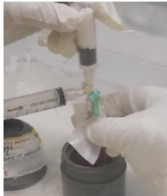
ガス交換が終わったら、ろ紙を使って引き抜く。
