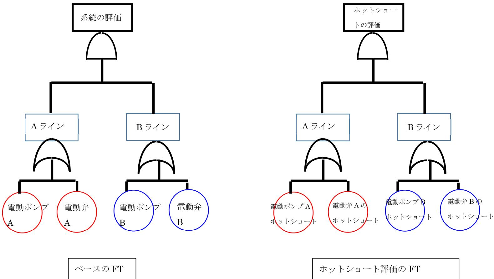
図 4.2-1、ホットショートにより発生する機器の基事象に置き換える FT の例
