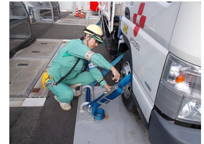
車両固縛解除の改善 (ハサミによる切断)
