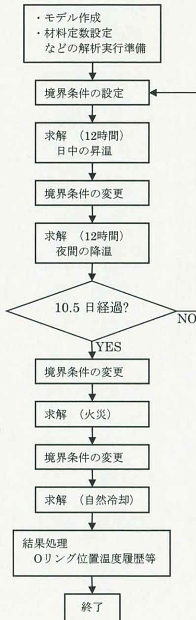
(ロ)B-第 20 図 特別の試験条件解析フロー
