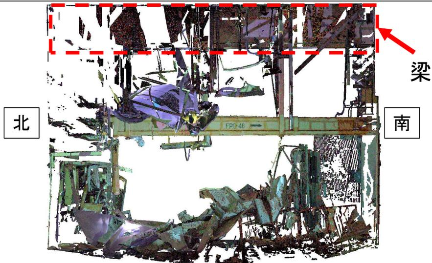
2020年8月の測定結果と2022年5月の測定結果を重ね合わせた図（データ）
