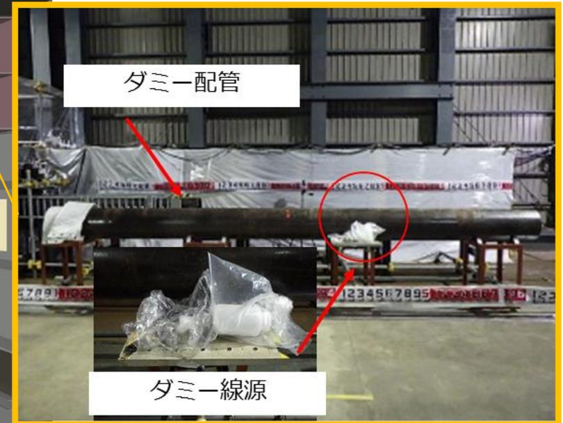
ダミーの配管内にダミー線源を設置し、γ線イメージングを実施
