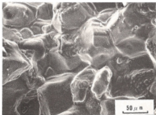
液化割れの例*3
