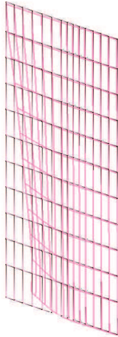
图 7-4(3) 変形図 (0.4Sd 水平_-1.0Sd 鉛直)
