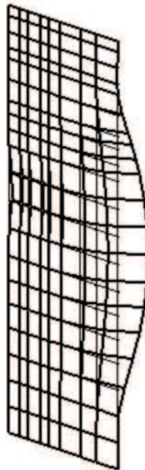
図 6-2(3) 変形図 (地下トレンチ② 左側)
