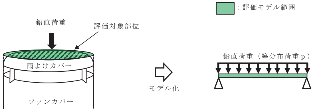
図 3-5 雨よけカバーのモデル図
