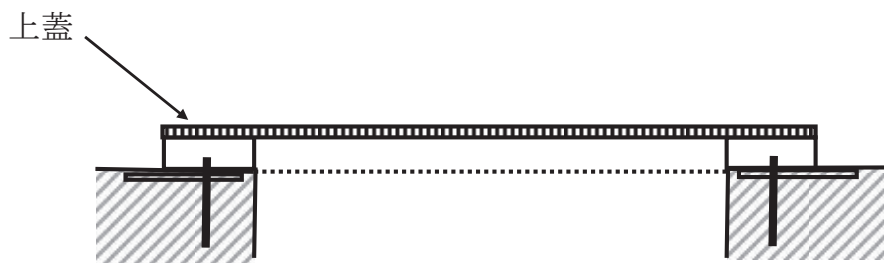
図 2-10 鋼製ハッチの評価対象部位
