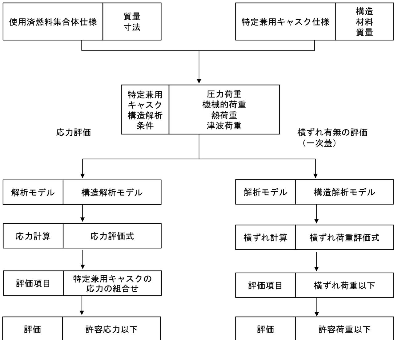
図1 津波荷重作用時の機能維持評価フローチャート
