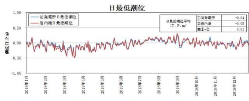
図 1.5-5 泊発電所と岩内港の日最低潮位の比較
