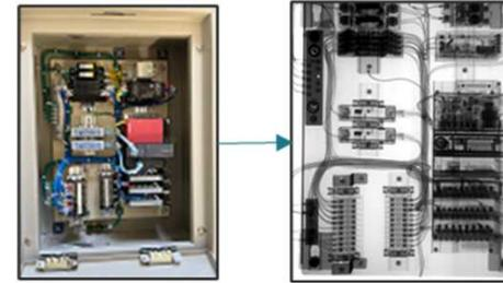
金属と有機物が混合したクリアランス対象物の内部の情報を用いて放射能を定量化する技術について検討
