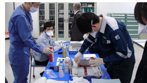
(浸透探傷試験の実習)
