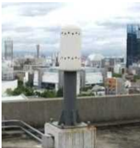
モニタリングポストにより測定
