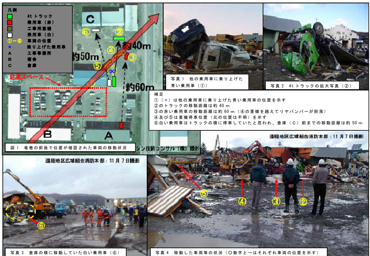
図 6.4-2 佐呂間竜巻(2006.11.7)による被災状況：工事事務所敷地内の車両被災(竜巻経路 → を追加)
