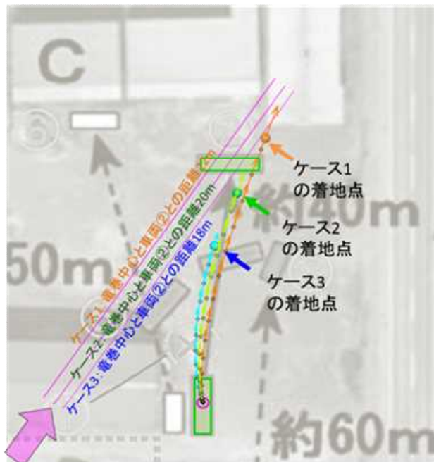
図 6.4-3 佐呂間竜巻での 4 t トラックの飛散計算結果
