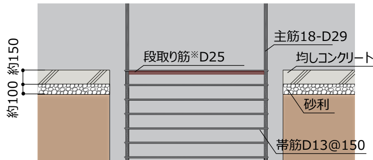
a部拡大図 (No.8杭損傷前)
