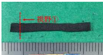
A蒸気発生器 第一管支持板上部（高温側）から回収した長尺型スケール
