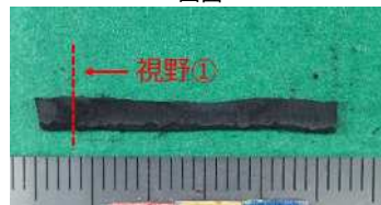
A蒸気発生器 第一管支持板上部（高温側）から回収した長尺型スケール
