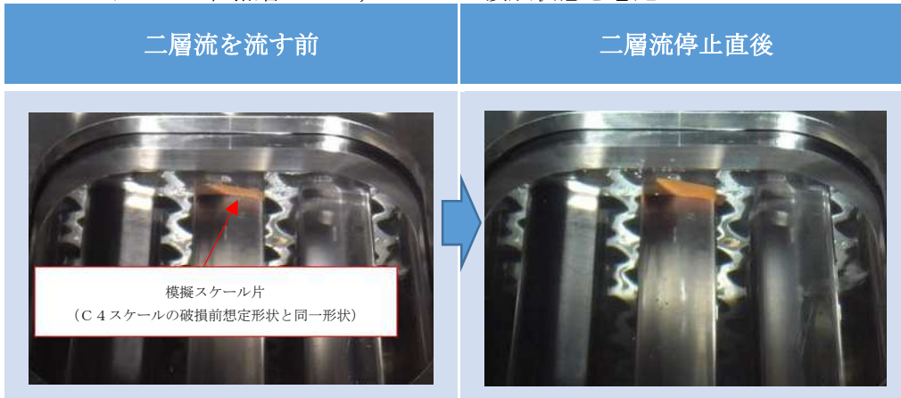
図2 水空気試験結果
