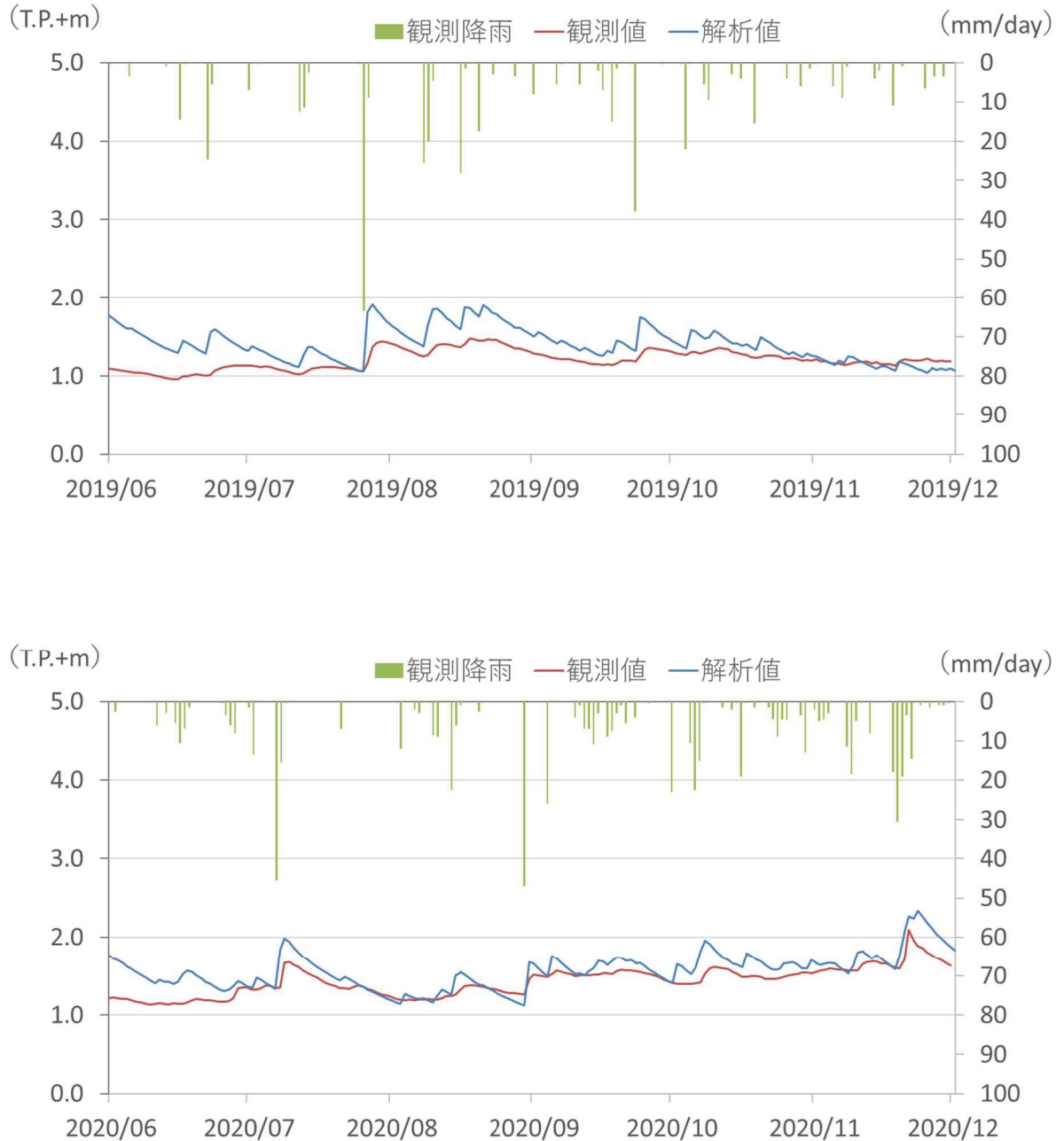
別紙 10-9(1)図 地下水位の経時変化例 (No.9 孔)
