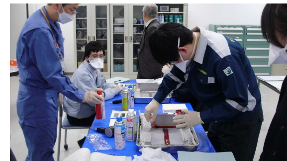
(浸透探傷試験の実習)
